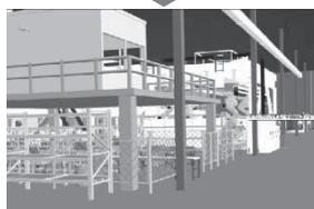
実寸大の3Dモデル内を歩き回って設備の配置を検証する
