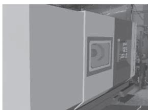
マーカーに新設設備のCADモデルを割り当てて移動することで搬入動線や周囲との干渉を確認
